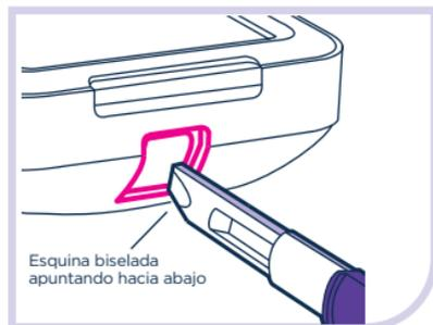
**Compruebe que la parte lateral de color de la varilla de prueba se encuentre en el costado derecho de la ranura de la varilla de prueba.**
